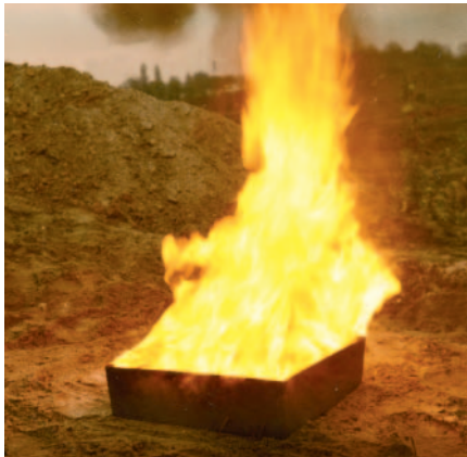
Leere Wanne ohne Wabenrost. Füllung 0,6 Liter N-Heptan, Flammenhöhe bis 2,2 Meter, vollständig verbrannt.
