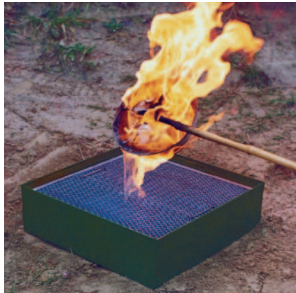
Wanne mit Wabenrost, Füllung in Portionen (3 x 2 Liter brennendes N-Heptan), Flamme verlischt 2-5 sec nach Einfüllung jeder 2-l-Portion.
